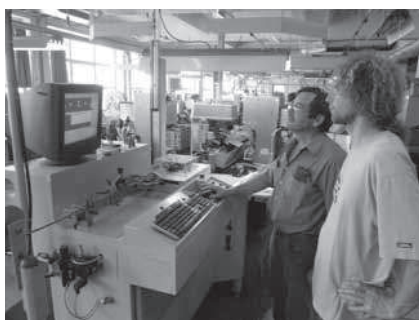
Jiří Ďurián a Petr Schmid při stříhání zapalovacích kabelů a lisování koncovek, Foto: Mgr. Jaromír Trpák
