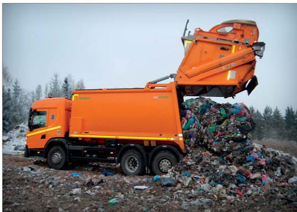
Ke svozu SKO slouží nízkopodlažní vozidlo Scania L 320 s nástavbou Ros Roca Olympus a vyklápěčem Terberg. Odpad končí na nedaleké skládce Hněvkov
